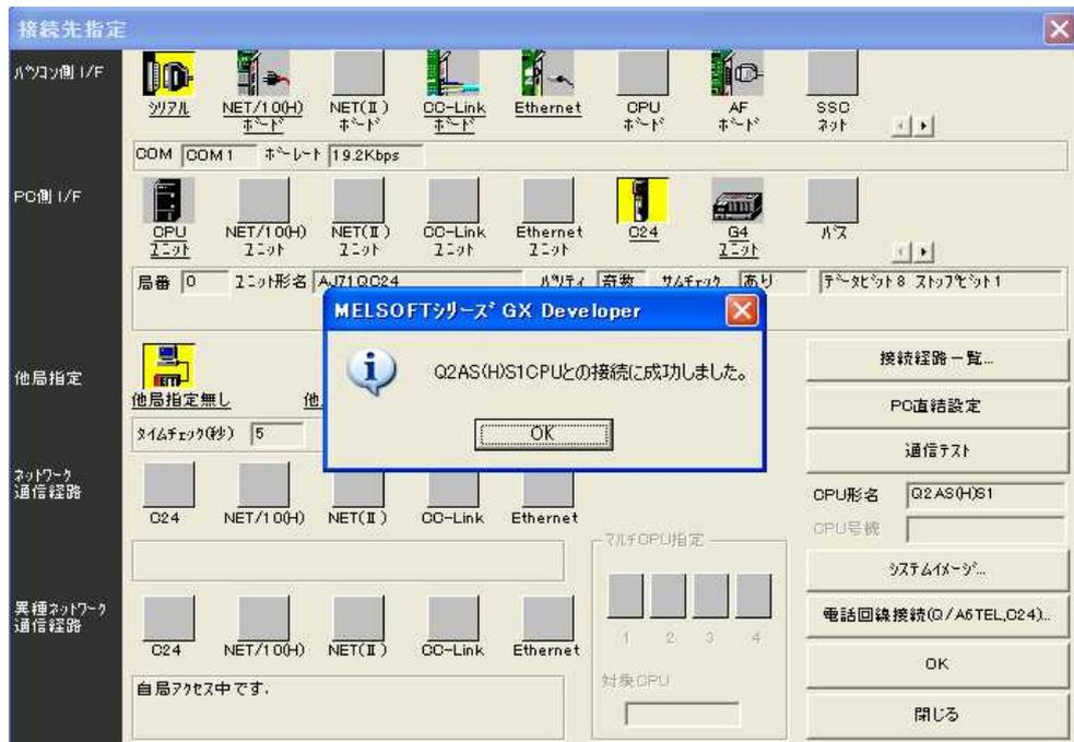
(6) 「メニューのオンライン」「モニタ」「モニタ開始」を実行して下さい。モニタステータスが表示され、画面上のラダープログラムのデバイスに現在の状態が表示されます。
